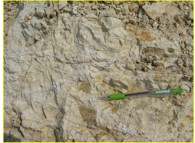
แสดงลักษณะหินภูเขาไฟเนื้อโรโอไลต์ สีเทาอ่อน ปรากฏสายแร่ควอตซ์ ในพื้นที่คำขอประทานบัตรที่ 6/2561 หมายเลขหลักหมายเขตเหมืองแร่ที่ 30539 บริเวณค่าพิกัด 560330E 2045381N
