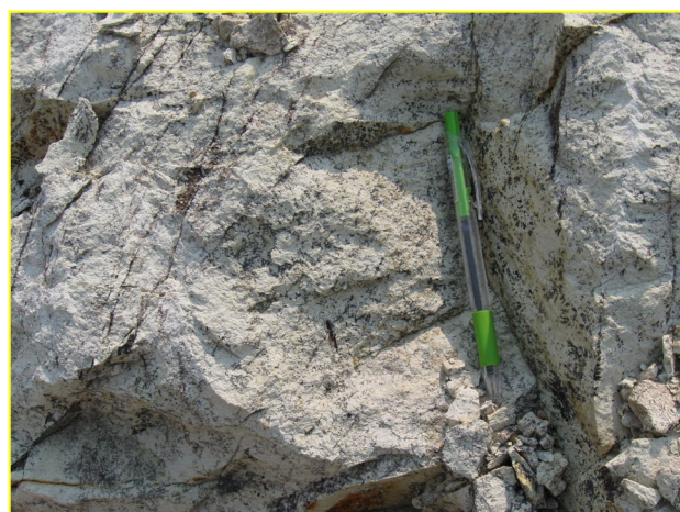
แสดงลักษณะแร่ดินขาวเนื้อหินพอทเทอรี่สโตน พบแร่ไพโรลูไซต์ (Pyrolusite) มีลักษณะเป็นป็นสีดำ รูปคล้ายกิ่งไม้หรือขนนก ฝังประในเนื้อหิน บริเวณค่าพิกัด 560302E 2045325N
