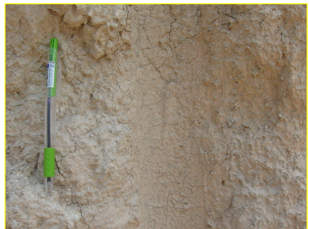
แสดงลักษณะหินภูเขาไฟเนื้อโรโอไลต์ สีขาวอมชมพู ค่อนข้างผุ ในพื้นที่คำขอประทานบัตรที่ 6/2561 หมายเลขหลักหมายเขตเหมืองแร่ที่ 30539 บริเวณค่าพิกัด 560330E 2045381N
