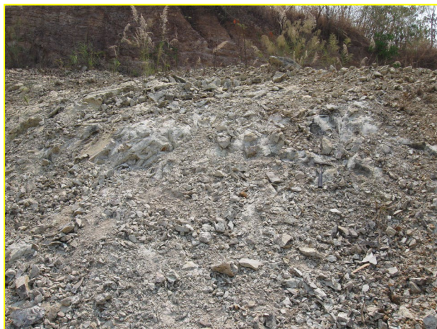
แสดงลักษณะแร่ดินขาวเนื้อหินพอทเทอรี่สโตน ในพื้นที่คำขอประทานบัตรที่ 6/2561 หมายเลขหลักหมายเขตเหมืองแร่ที่ 30539 บริเวณค่าพิกัด 560302E 2045325N
